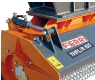
Motorhaubenöffnung mit hydraulischem Zylinder.
