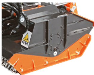
Motorhaubenöffnung mit hydraulischem Zylinder.
