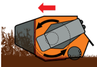
Drehrichtung des Rotors, Gras / Unkraut.
