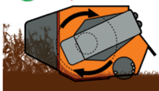
Drehrichtung des Rotors, Gras / Unkraut.
