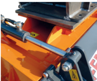
Motorhaubenöffnung mit hydraulischem Zylinder.
