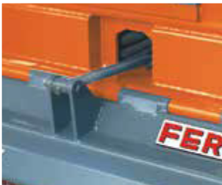
Motorhaubenöffnung mit hydraulischem Zylinder.
