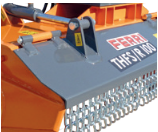
Motorhaubenöffnung mit hydraulischem Zylinder.
